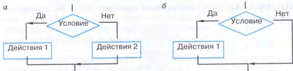
Рис. 2.9. Структура «ветвление»: а — полная форма ветвления; б — неполная форма ветвления
